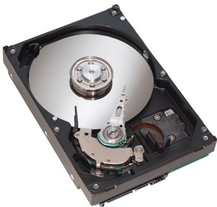
— Disque dur, années 2000 Vue d'un disque dur ouvert.
